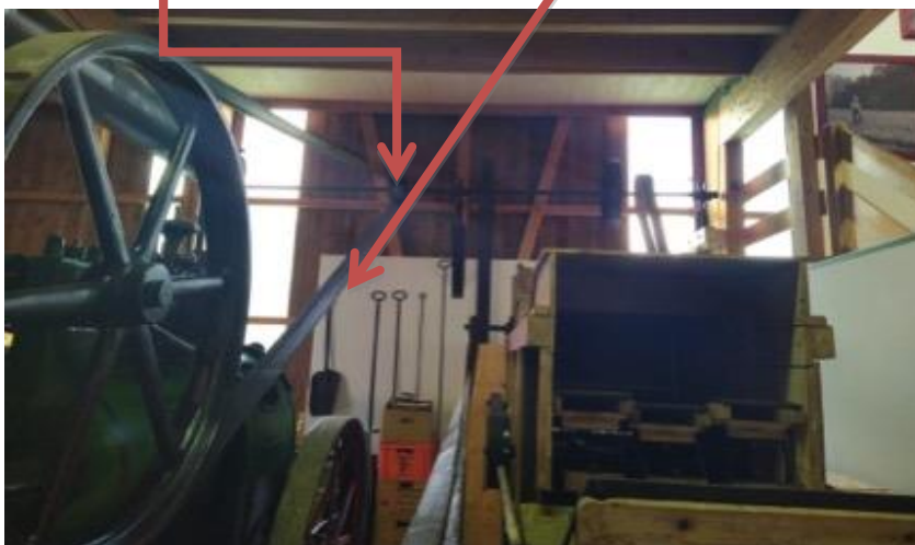
Abbildung 3: Dreschmaschine «Aebi» angetrieben durch das Dampflok «Lanz»
